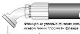
Фланцевые угловые фитинги измеряют по осевой линии плоскости фланца
