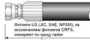
Фитинги US (JIC, SAE, NPSM), за исключением фитингов ORFS, измеряют по концу гайки
